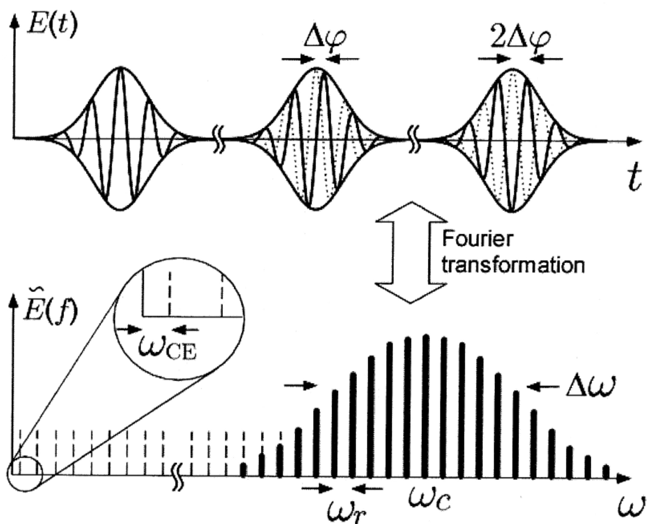
Durch Messung des Abstands  $f_r = \frac{\omega_r}{2\pi}$  und des Offsetes  $f_0 = \frac{\omega_r}{2\pi}$  sind sämtliche Frequenzen des Kamms bestimmt. Beide Frequenzen sind im Radiobereich ( $\sim 1\text{GHz}$ ) und lassen sich elektronisch zählen ( $\Delta f \sim 1\text{Hz}$ ). Der Sprung zu optischen Frequenzen  $f_n = f_0 + n f_r$  ( $\sim 10^{15}\text{Hz}$ ) geschieht durch sehr große  $n \sim 10^6$ . Es ist erstaunlich, daß die
