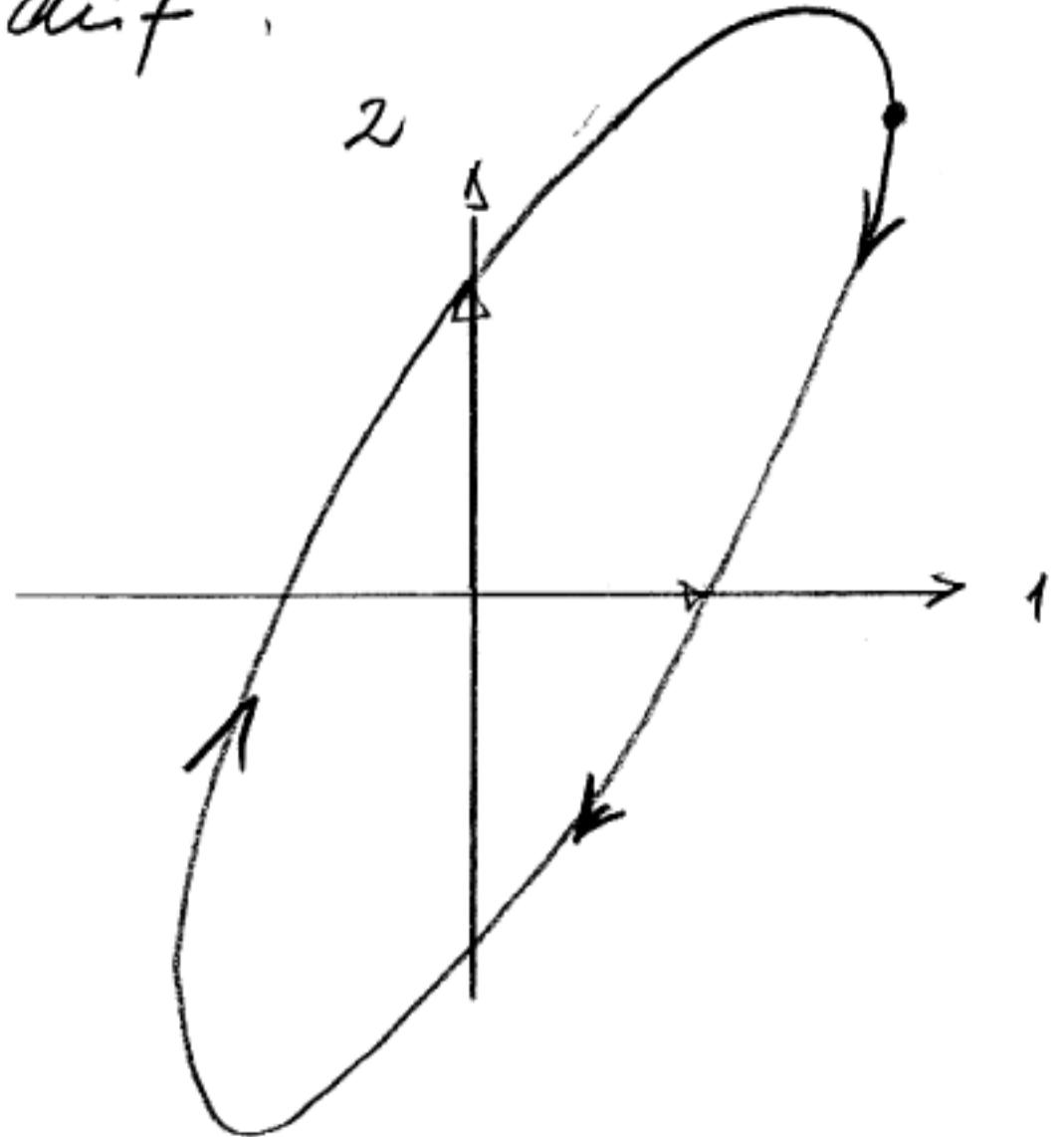
In jedem  $\vec{k}$  gibt es 2 linear unabhängige linear polarisierte Wellen, die allgemeine Welle ist eine Superposition von 2 linear polarisierten Wellen.
